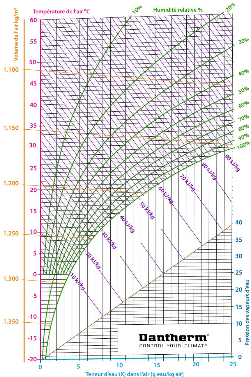
Le diagramme du Mollier hx est une représentation graphique de l'interrelation de la température et l'humidité relative de l'air. Ce diagramme est la clé pour déterminer les différents paramètres nécessaires pour calculer la charge de déshumidification nécessaire dans toute circonstance donnée.
