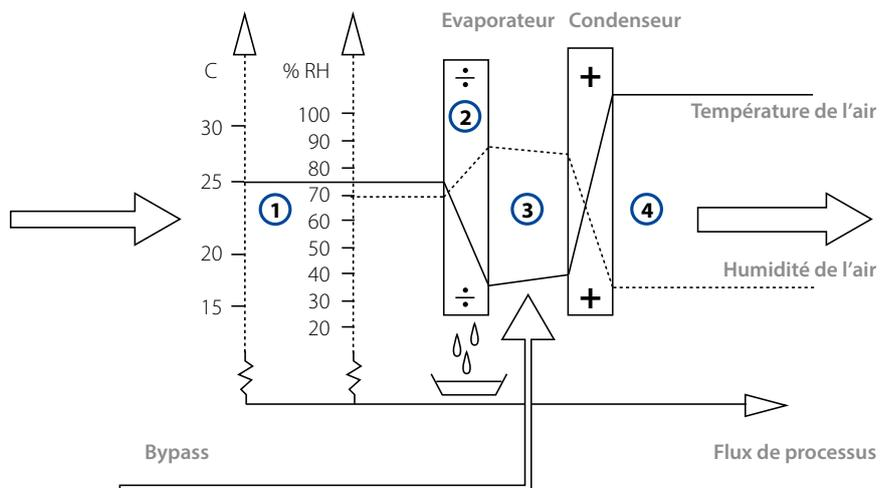
Dans l'exemple illustré sur la page précédente, de l'air chaud à 25°C (1) avec 70% HR (Humidité Relative) entre par l'évaporateur. A l'intérieur de l'évaporateur réfrigéré (2), la température de l'air redescend à 17°C et la HR augmente jusqu'à 88%, provoquant la condensation et le ruissèlement de l'eau dans un récipient.
