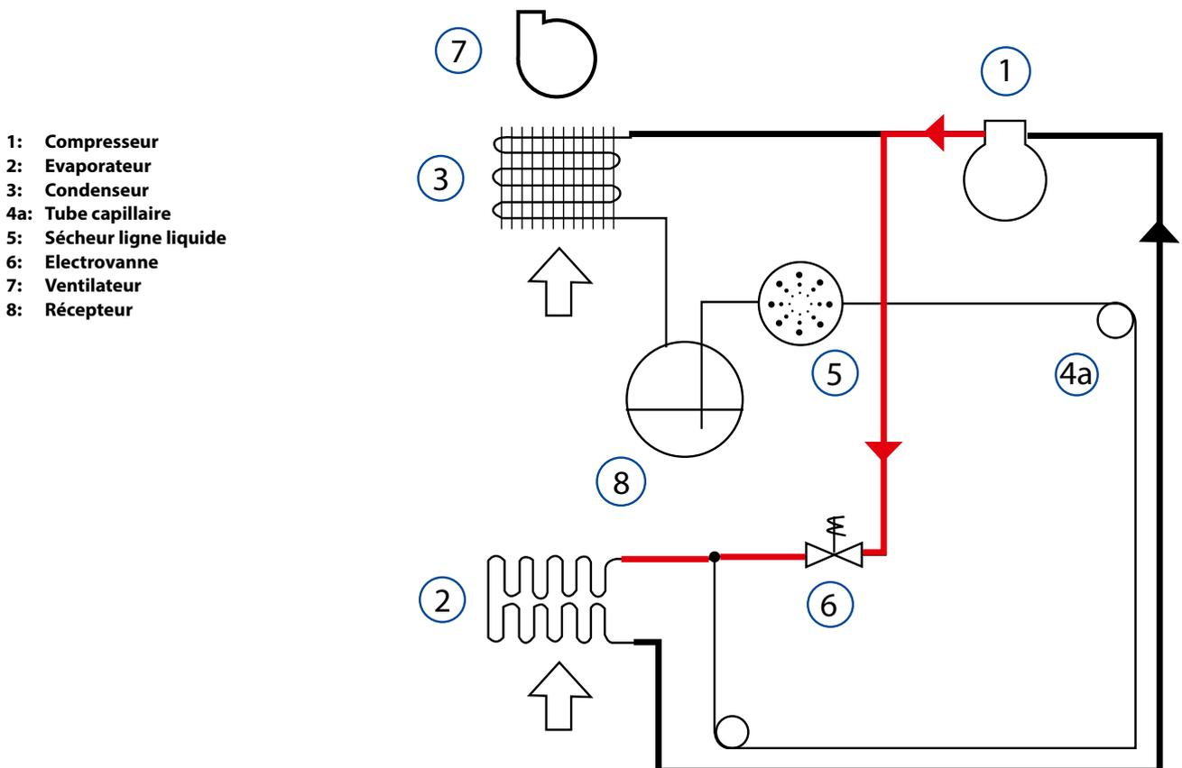
Lorsque la température réglée à 5°C est atteinte sur la surface de l'évaporateur, le temporisateur est activé et 30 minutes plus tard l'électrovanne (6) s'ouvre et le gaz chaud commence à nettoyer l'évaporateur, en fondant de manière efficace la glace de la surface. Lorsque la température pré réglée est atteinte, l'électrovanne ferme et le système repasse de nouveau en mode actif.
